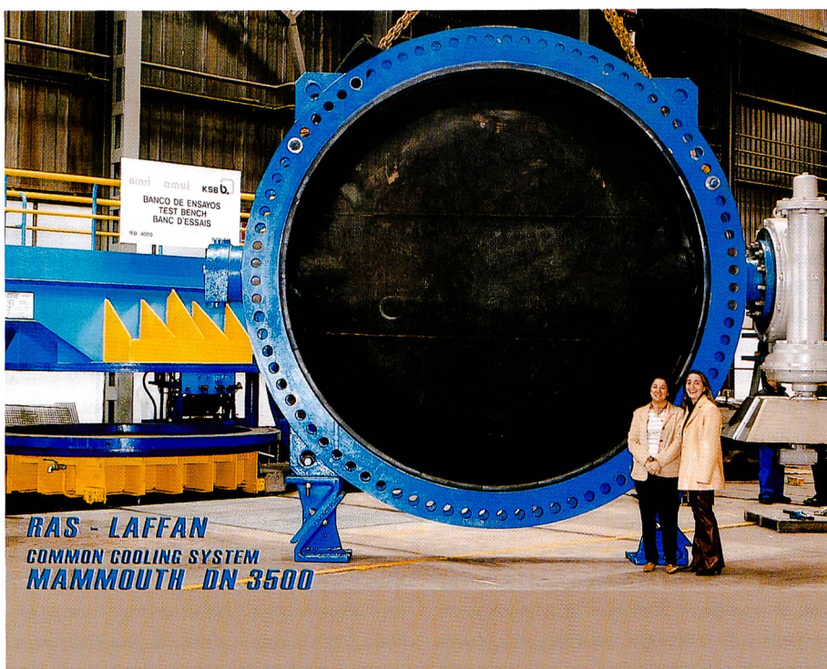
Bild. Absperrklappen mit einem Innendurchmesser von 3500 mm.
