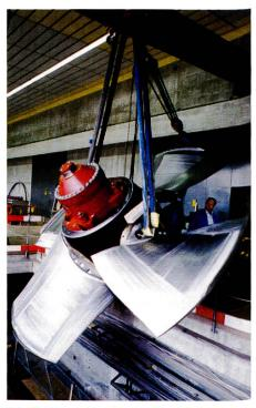
Bild 3. Neues Turbinenlaufrad bei der Montage.
