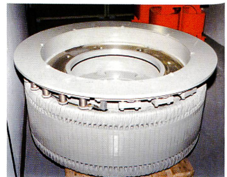
Bild 4. Erregerrotor mit Diodenbrücke.
