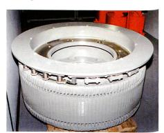
Bild 4. Erregerrotor mit Diodenbrücke.
