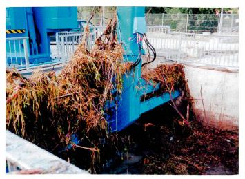
Bild 5. Greiferharke schliesst sich über der Wasseroberfläche.
