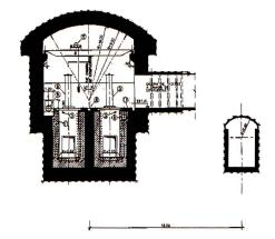
Bild 3. Los Caracoles – Querschnitt der Grundablasskammer mit Bypass-Stollen.
