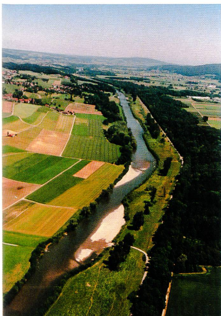
Bild 6. Abschnitt Ror-Uesslingen. Die neu gestaltete Thur oberhalb Uesslingen; Mittelgerinne mit Aufweitungen und Kiesbänken.
