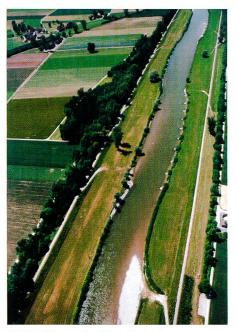
Bild 7. Wechselseitige Aufweitungen.
