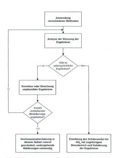
Bild 3. Hochwasserabschätzung in mittelgrossen Einzugsgebieten ohne Abflussmessung.
