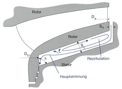
Bild 1. Strömung und Geometrieparameter im RSR.
