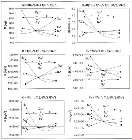
Bild 6. Einfluss der RSR-Geometrie auf die rotordynamischen Koeffizienten.
