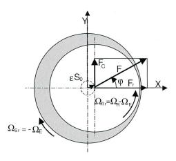
Bild 4. Konzentrische Orbitbewegung des Rotors im absoluten und im relativen Koordinatensystem, Amoser (Ref. 9).
