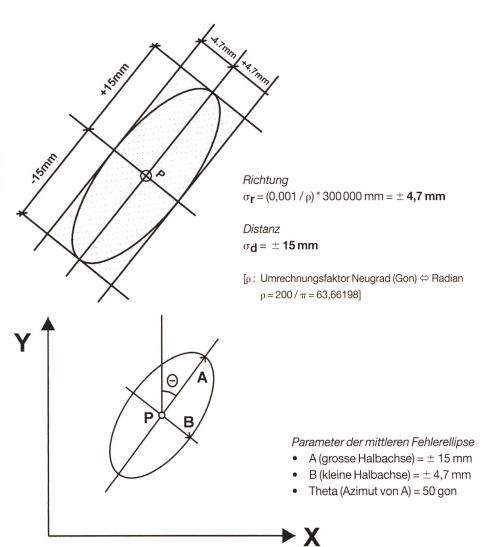
Bild 4. Die Fehlerellipse bei einer Lagebestimmung mittels Abstands- und Richtungsmessung.
