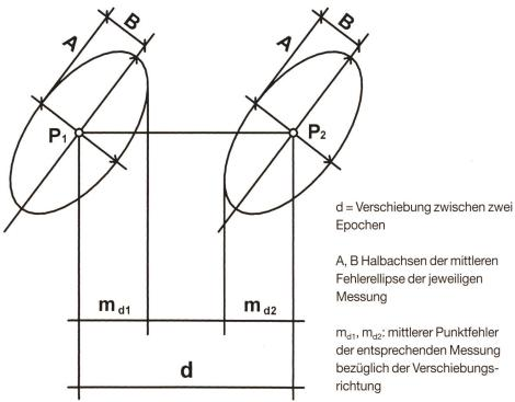
Bild 5. Definitionsskizze für die Verschiebung zwischen zwei unabhängigen Messepochen.
