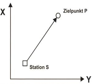
Von einer Station S aus wird ein Punkt P mit einer Distanz von 300 m und einem Azimut von 50 gon polar aufgenommen. Die mittleren Fehler der Beobachtungen betragen z.B.  $\pm$  0,001 gon für die Richtung und  $\pm$  15 mm für die Distanz.
