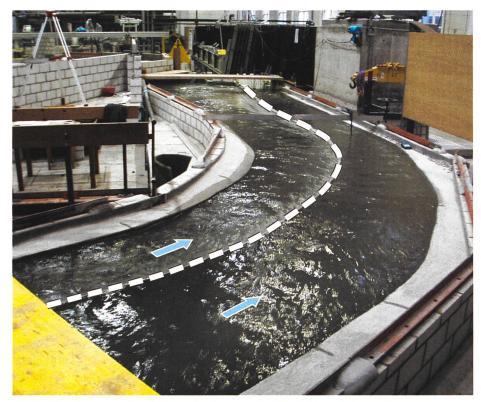
Bild 2. Physikalisches Modell des Kraftwerkes Schiffmühle bei einem Abfluss von 600 m³/s. Bei grossen Abflüssen gleichen sich die Wasserspiegel im Oberwasserkanal (rechts) und in der Restwasserstrecke (links) zunehmend an. Das Streichwehr ist durch eine weisse Strichlinie hervorgehoben.
