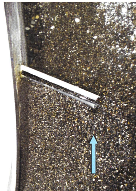
Bild 5. Wirbelröhre «Omega», Versuchsende nach einer hydraulischen Belastung entsprechend der Geschiebe führenden Abflüsse des Jahres 1999; Erkennbar ist die Anpassung der Geschiebebank an die angeströmte Seite der Wirbelröhre.
