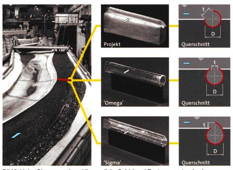
Bild 3. Links: Oberwasserkanal (bewegliche Sohle) und Restwasserstrecke des physikalischen Modells mit angedeuteter Wirbelröhre. Mitte: Modelle der untersuchten Wirbelröhrentypen. Rechts: Röhrenquerschnitte.
