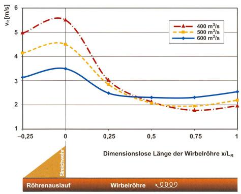
Bild 4. Längskomponente der Fliessgeschwindigkeiten  $v_R$  entlang der Röhrenachse in Abhängigkeit des Gesamtabflusses der Limmat in der Wirbelröhre Typ «Omega» bei Abflüssen von 400 m³/s, 500 m³/s und 600 m³/s.
