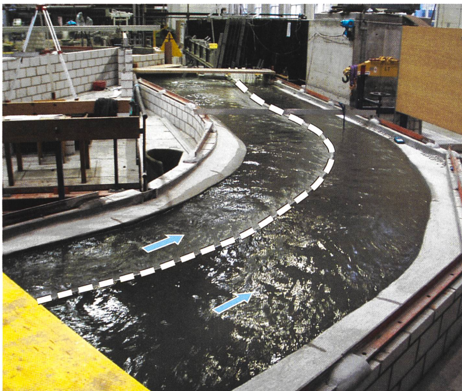
Bild 2. Physikalisches Modell des Kraftwerkes Schiffmühle bei einem Abfluss von 600 \text{ m}^3/\text{s} . Bei grossen Abflüssen gleichen sich die Wasserspiegel im Oberwasserkanal (rechts) und in der Restwasserstrecke (links) zunehmend an. Das Streichwehr ist durch eine weisse Strichlinie hervorgehoben.
