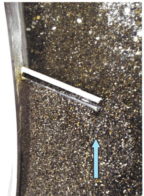
Bild 5. Wirbelröhre «Omega», Versuchsende nach einer hydraulischen Belastung entsprechend der Geschiebe führenden Abflüsse des Jahres 1999; Erkennbar ist die Anpassung der Geschiebebank an die angeströmte Seite der Wirbelröhre.
