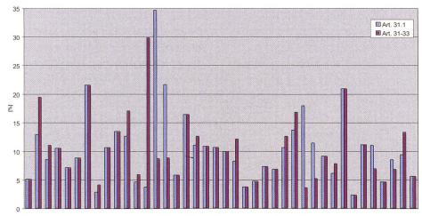
Bild 4. Produktionseinbussen bei Ausleitkraftwerken aufgrund der Restwassermengen nach Artikel 31 Absatz 1 bzw. aufgrund der konzessionierten Restwassermenge nach Artikel 31–33 GSchG in %.
