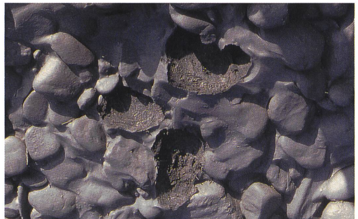
Bild 11. Sohlenbereich mit äusserer und innerer Kolmation. Die innere Kolmation zeigt sich beim Entfernen der Deckschichtsteine (in Bildmitte). Ablagerungen von Feinsand und kohäsiven Schwebstoffpartikeln (Silt, Ton).
