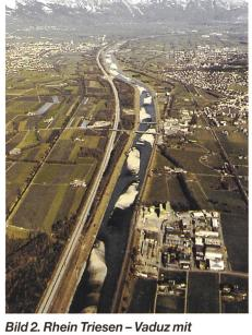
Bild 2. Rhein Triesen – Vaduz mit alternierenden Bänken (ähnlich wie Teststrecken Bad Ragaz und Buchs). Blick in Fliessrichtung.
