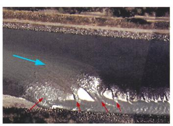
Bild 9. Teststrecke Bad Ragaz, Erosionen im Bereich einer Schnelle (rote Pfeile). Luftbild vom 7.3.00.
