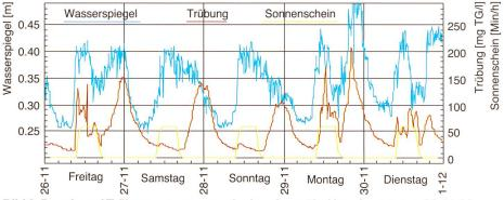
Bild 6. Pegel- und Trübemessungen an der Landquart bei Landquart vom 26.11. bis 30.11.99 sowie Sonnenscheindauer (Chur). Die Trübeschwälle stehen in direktem Zusammenhang mit der Besonnung des unteren Einzugsgebiets und dem Abflussschwall in der Landquart. TG = Trockengewicht.
