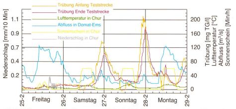
Bild 7. Trübemessung Bad Ragaz vom 25.2. bis 28.2.00 an zwei Standorten (Abstand Sonden Anfang und Ende Teststrecke ca. 2,4 km), Abfluss bei Domat/Ems sowie Verlauf der Lufttemperatur, der Besonnung und des Niederschlags bei Chur.
