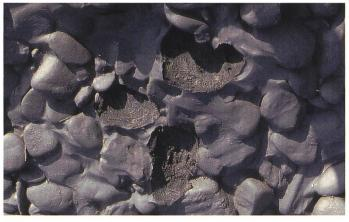
Bild 11. Sohlenbereich mit äusserer und innerer Kolmation. Die innere Kolmation zeigt sich beim Entfernen der Deckschichtsteine (in Bildmitte). Ablagerungen von Feinsand und kohäsiven Schwebstoffpartikeln (Silt, Ton).
