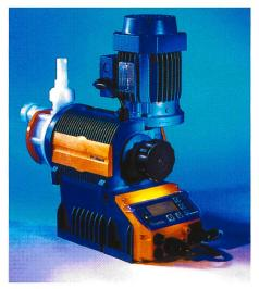
Bild 1. Die neue Sigma/1-Dosierpumpe komplettiert diese Baureihe für den unteren und mittleren Leistungsbereich von 1 I/h bis 1000 I/h bei ProMinent. Ihre Mikroprozessor-Steuerung mit optimaler Kombination aus Drehzahlregelung und Stop-and-go-Betrieb gewährleistet exaktes Dosieren, auch im unteren Minimalbereich.
