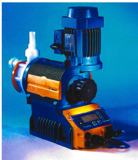
Bild 1. Die neue Sigma/1-Dosierpumpe komplettiert diese Baureihe für den unteren und mittleren Leistungsbereich von 1 l/h bis 1000 l/h bei ProMinent. Ihre Mikroprozessor-Steuerung mit optimaler Kombination aus Drehzahlregelung und Stop-and-go-Betrieb gewährleistet exaktes Dosieren, auch im unteren Minimalbereich.
