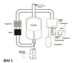
stirlinggenerator wäre aber noch ein sehr hoher Entwicklungsaufwand erforderlich. Insbesondere das Problem einer wartungsfreien, trocken laufenden Kolbendichtung bei Differenzdrücken von 80 bar scheint mit vertretbarem Aufwand kaum lösbar. An diesem
