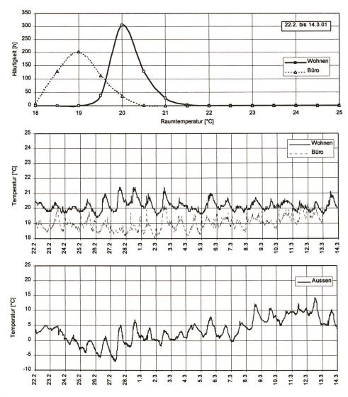
Bild 2. In der Messperiode mit der modellbasierten Pulsbreitenmodulation erreichte Raumtemperaturverteilung im Wohnzimmer und im Büro mit Vergleich zur Aussentemperatur [aus Schlussbericht].
