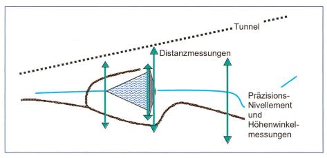
Bild 5. Schematische Darstellung des zusätzlichen Überwachungssystems. Es dient zur Beobachtung allfälliger Geländeverformungen in der näheren und weiteren Umgebung der Talsperren sowie zur Beweissicherung und als Alarmglocke.
