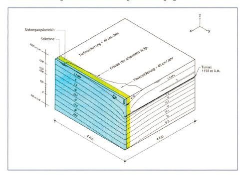
Bild 3. Deformationen des Felsmassivs, hervorgerufen durch die Gebirgsdrainage und Absenkung des Bergwasserspiegels. Validierung des Rechenmodells zur Beschreibung der hydraulischmechanisch gekoppelten Vorgänge im geklüfteten, elastischen und wassergesättigten Gebirge (F.E.S.-Modell nach Lombardi) anhand der zwischen 1970 und 1997 durch das Bundesamt für Landestopografie gemessenen Setzungen, die der Bau des Gotthard-Strassentunnels verursacht hatte.
