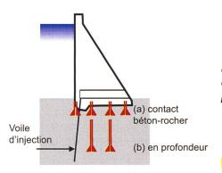
Figure 8. Barrage en béton. Mesures des sous-pressions au contact béton-rocher (a) et en profondeur (b).
