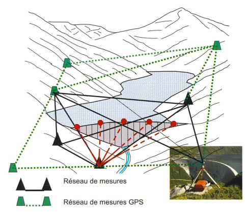
Figure 6. Schéma de réseaux de mesures géodésiques.
