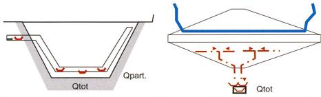
Figure 7. Barrages en béton et en remblai: Mesures des débits d'infiltration totaux Qtot et partiels.
