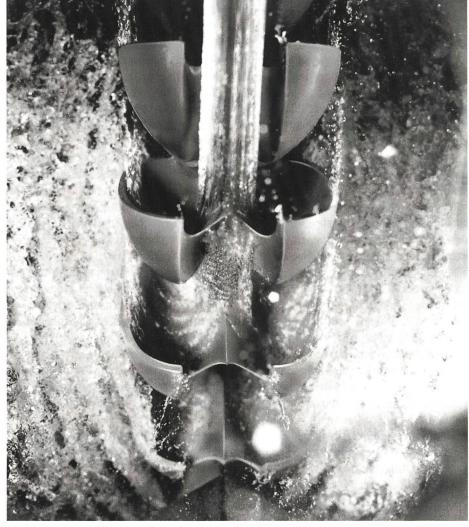
Bild 1. Nutzung der Wasserkraft im Pelton-Turbinenrad.
