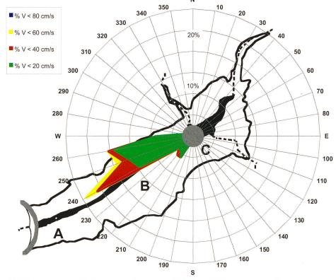
Bild 5. Gemessene Richtung und Geschwindigkeit der Trübeströme im Stausee Luzzone am Standort C (gemäss Bild 4) 4 m über Seegrund: Die Richtung ist in Geschwindigkeitsintervalle aufgeteilt. Die Strömung folgt gut sichtbar dem Talweg (gemäss [7]).
