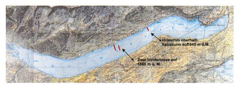
Bild 10. Grimselstausee mit den untersuchten Hindernisstandorten zur Bremsung der Trübeströme.
