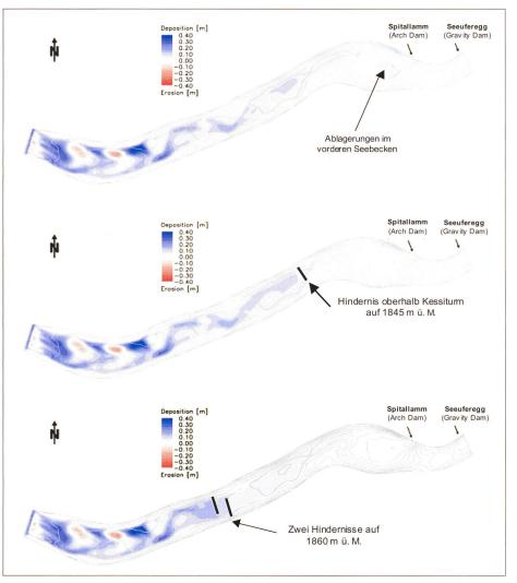
Bild 11. Ablagerungen und Erosionen eines im Grimselstausee simulierten Trübestroms während des Hochwassers vom Oktober 2000 (Abflussspitze 40 m³/s, angenommene Sedimentkonzentration 15 g/l).
