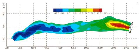
Bild 6. Gerechnete Erosionen und Ablagerungen infolge eines Trübestromes im Stausee Luzzone nach vollständiger Absetzung der Feinsedimente. Die Sedimente werden massiv vom oberen in den unteren Teil des Beckens umgelagert (maximale Erosion 27 cm, maximale Ablagerung 53 cm) [7].
