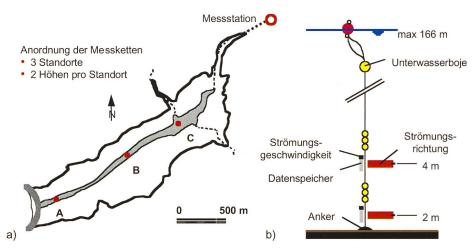
Bild 4. Anordnung der Messketten an drei Standorten im Stausee Luzzone (links) und deren Elemente mit zwei Strömungsmessern (rechts) (gemäss [7]).
