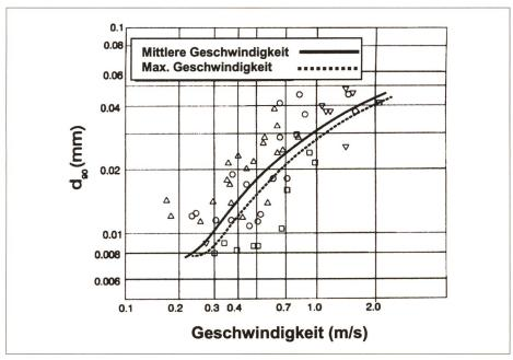
Bild 8. Maximal transportierbarer Korndurchmesser in Abhängigkeit der Fliessgeschwindigkeit des Trübestroms gemäss [16].
