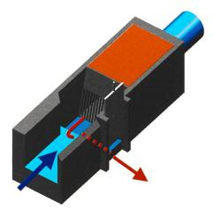
Bild 5. Kostengünstige Rechenanlage ohne Rechenreinigungsmaschine.
