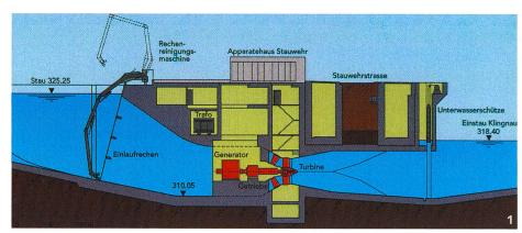
Bild 9. Schnitt durch das Wehrkraftwerk Beznau.
