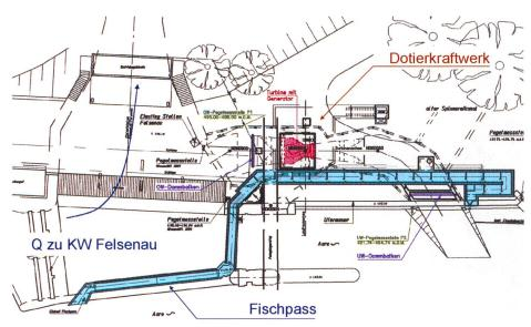
Bild 14. Grundriss des Dotierkraftwerks und Fischpasses Engehalde.
