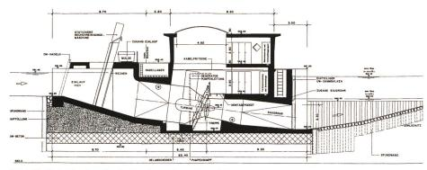
Bild 12. Schnitt durch die Dotieranlage Interlaken.
