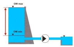
Bild 2. Dotierkraftwerk an Talsperre.
