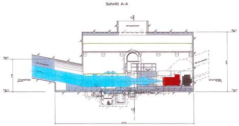
Bild 16. Schnitt durch das Dotierkraftwerk Pfaffensprung.
