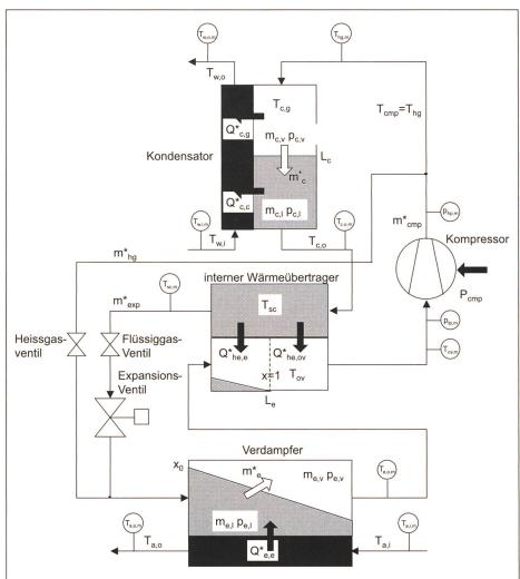
Bild 4. Fliessbild der simulierten Wärmepumpe mit innerem Wärmeübertrager (Sauggasüberhitzer).
