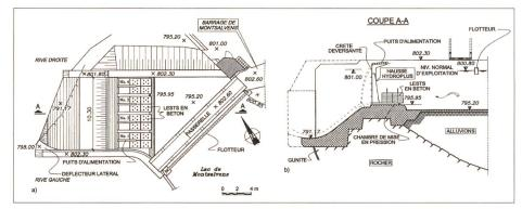
Figure 3. Evacuateur de crues en rive gauche après les travaux de renouvellement; a) vue en plan et b) coupe type.
