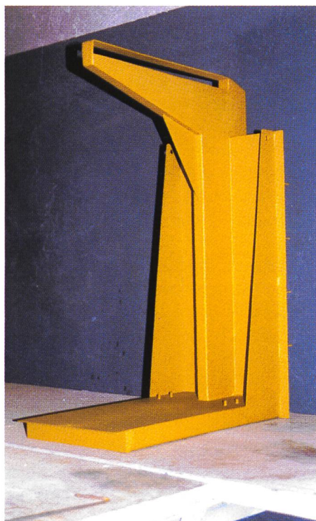
Figure 4. Hausse fusible du modèle à l'échelle 1 : 10 avec alimentation conventionnelle du puits de mise en pression de la chambre de basculement; a) vue aval et b) vue amont.
