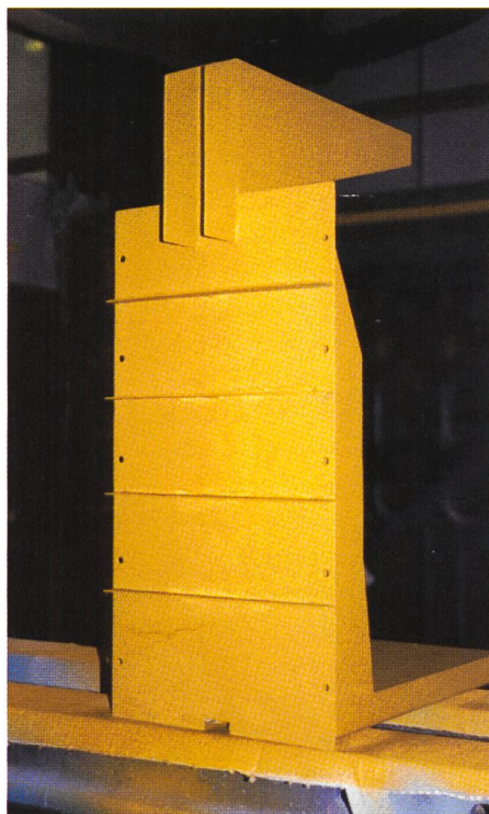
Figure 4. Hausse fusible du modèle à l'échelle 1 : 10 avec alimentation conventionnelle du puits de mise en pression de la chambre de basculement; a) vue aval et b) vue amont.
