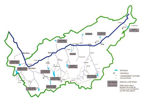
Figure 3. Rétention dans les bassins d'accumulation des aménagements hydroélectriques valaisans.
