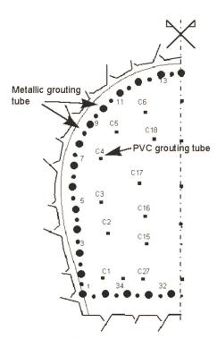
Figure 5. Schéma d'injection.
