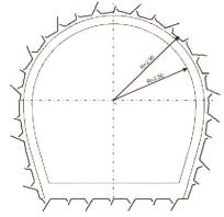
Figure 2. Profil type d'excavation.
