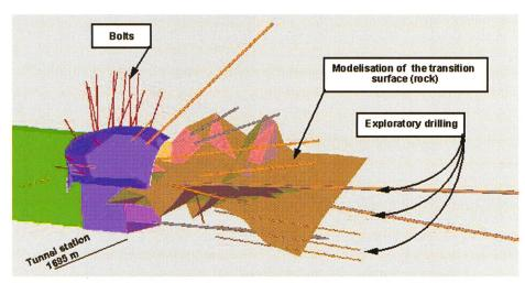
Figure 3. Modèle géologique avec sondages de reconnaissances au TM 1695.
