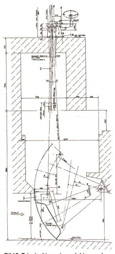
Bild 3. Prinzipskizze eines elektromechanischen Antriebs einer Schütze.
