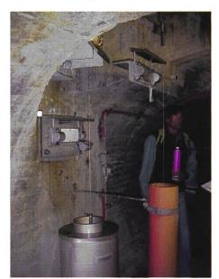
Bild 4. Vorrichtungen für manuelle Messung der Lote. Sie bleiben weiterhin bestehen.
