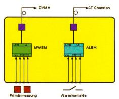
Bild 8. Erfassung analoge Primärmesswerte und digitale Alarmmeldungen.
