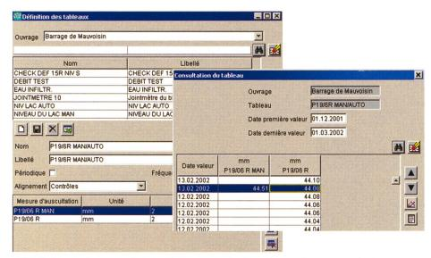
Bild 16. Auswertung von Sektor 19, Lot 19. In der Tabelle werden automatisch erhobene Stundenwerte mit periodisch erfassten Handmessungen verarbeitet.
