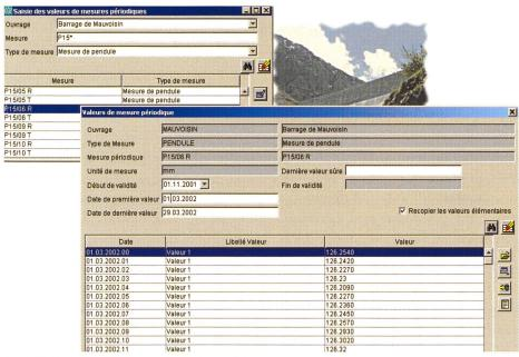
Bild 15. Verarbeitung automatischer Messwerte.
