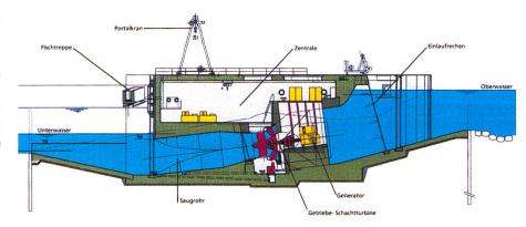
Bild 4. Längsschnitt durch das neue Maschinenhaus.
