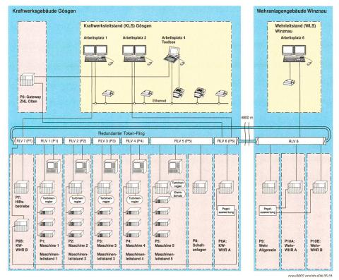
Bild B8-2. Topologie der Kraftwerksleittechnik Gösgen.
