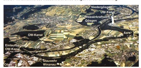
Bild B1-2. Luftaufnahme der gesamten Stauanlage Gösgen mit dem Wehr Winznau, dem Einlaufbauwerk, dem Oberwasserkanal, dem Wasserkraftwerk Gösgen und dem Unterwasserkanal.
