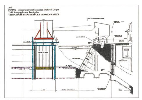
Bild B6-4. Baugrubensicherung und Dienstbrücke OW.
