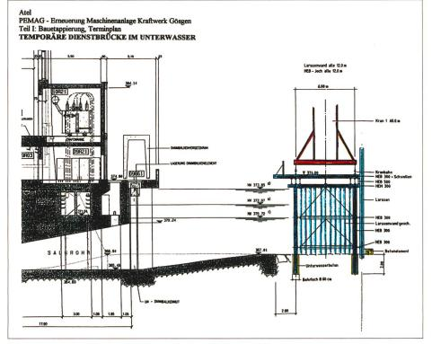
Bild B6-5. Baugrubensicherung und Dienstbrücke UW.
