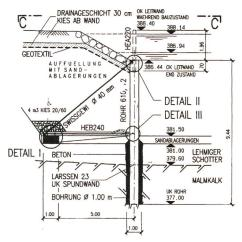
Bild B6-7. Linke Leitmauer im Oberwasser.
