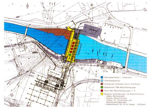
Bild B5-1. Übersichtssituation mit der alten und der neuen Einteilung der Maschinengruppen.
