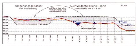
Bild A8-8. Querschnitt durch alten Kraftwerkskanal und Planie.
