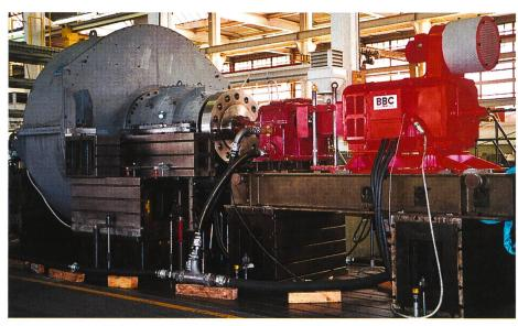
Bild A5-2. Getriebe beim Hersteller Maag auf dem Prüfstand.
