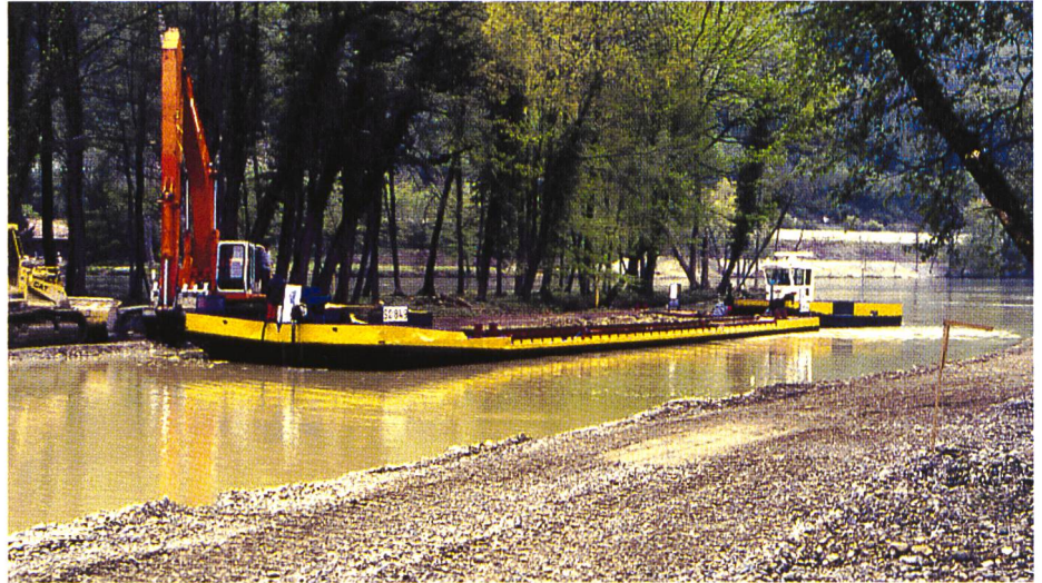
Bild A8-2. Kiestransport mit Schiff (Klappschute) zwischen den Boniger Inseln.
