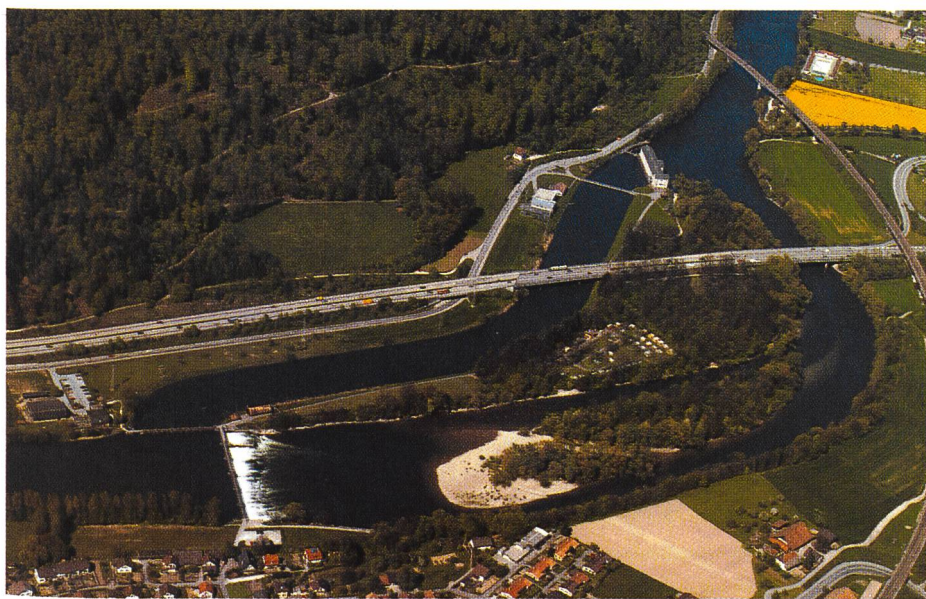
Bild A1-2. Die Anordnung der alten Anlage, mit einem Stauwehr in der Aare, einem Einlaufwehr zum langen Oberwasserkanal und dem Maschinenhaus am oberen rechten Bildrand. Im eigentlichen Aarebett bildeten sich die Ruppoldinger Inseln. Die Nationalstrasse A1 wie auch die SBB queren die Flusslandschaft.
