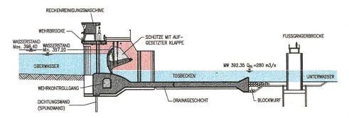
Bild A4-6. Längsschnitt Wehr.
