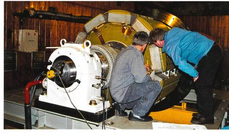
Bild A5-3. Generator beim Schleuderversuch.
