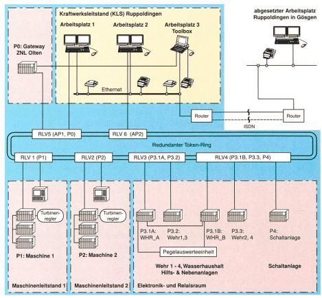
Bild A6-1. Topologie der Kraftwerksleittechnik Ruppoldingen.
