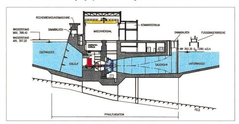
Bild A4-8. Längsschnitt Maschinenhaus.
