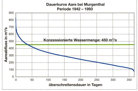
Bild A3-1. Dauerabflusskurve der Aare bei Murgenthal.
