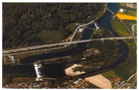
Bild A1-2. Die Anordnung der alten Anlage, mit einem Stauwehr in der Aare, einem Einlaufwehr zum langen Oberwasserkanal und dem Maschinenhaus am oberen rechten Bildrand. Im eigentlichen Aarebett bildeten sich die Ruppoldinger Inseln. Die Nationalstrasse A1 wie auch die SBB gueren die Flusslandschaft.
