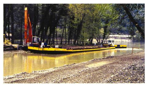
Bild A8-2. Kiestransport mit Schiff (Klappschute) zwischen den Boniger Inseln.
