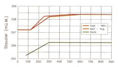
Bild A8-1. Variables Staureglement in Abhängigkeit vom Aareabfluss.
