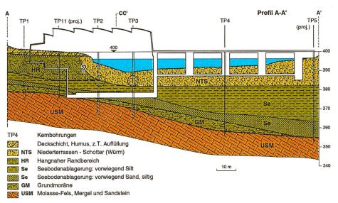
Bild A2-1. Geologisches Profil entlang der Werksachse (Prognose 1995).
