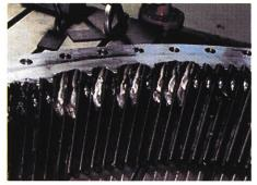
Bild 3. Sekundärschaden am Hohlrad der Maschine M2.
