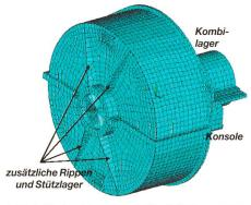
Bild 8. Finite-Elemente-Modell des neuen Getriebegehäuses mit dem zusätzlichen Stützlager (links) und Rippenversteifungen zur Verbesserung der Stabilität von Gehäuse und Lagerschale.
