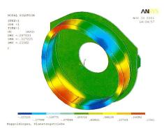
Bild 6. Mit FE berechnete Deformation des Hohlrades (Aussendurchmesser 3340 mm) im Volllastbetrieb und zu einem frei gewählten Zeitpunkt des Zahneingriffes der drei Planetenräder am Hohlrad. Eingefärbt ist die radiale Deformation. Die Kraftverteilung ist hier auf den Zahnflanken über der Zahnbreite von 450 mm gleichmässig angenommen worden.
