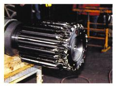
Bild 4. Sekundärschaden am Sonnenritzel der Maschine M1.
