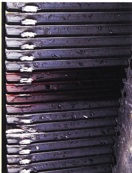
Bild 5. Tragbild an den belasteten Zahnflanken des Hohlrades der Maschine M2.
