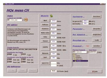
Bild 1. Länderbericht Schweiz, Teilbericht GIUB: Hauptformular des Softwarepaketes HQ<sub>x</sub>\_meso\_CH der Universität Bern zur Abschätzung von Hochwasserspitzen mesoskaliger Einzugsgebiete.
