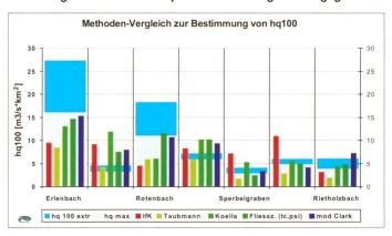
Bild 2. Länderbericht Schweiz, Teilbericht WSL: Methodenvergleich von fünf Verfahren zur Abschätzung der Abflussspitzen in Kleinsteinzugsgebieten (F. Forster, C. Hegg).
