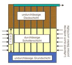
Bild 1. Prinzip der Anordnung der durchlässigen Absaugrohre. Im untersuchten Beispiel für eine Wärmepumpe mit 8,5 kW Heizleistung: 18 Rohre mit 75 mm Durchmesser in einem Abstand von 3,33 m (aus Schlussbericht).
