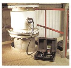
Bild 1. Die Überpüfung des angeschlossenen Magflo®-Messumformers und Durchfluss-Messaufnehmers mit dem Verificator dauert nur 15 Minuten. Die Speicherkapazität reicht für die Prüfung von maximal 20 Geräten. Spätestens dann muss man die Messdaten herunterladen (Werkfoto Danfoss).
