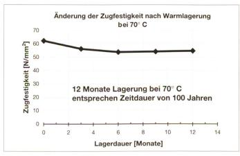
Bild 7. Alterungstest Teilbereich Abdichtungsmembrane; Änderung Zugfestigkeit.
