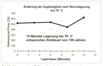
Bild 8. Alterungstest Teilbereich Abdichtungsmembrane; Dehnungsänderung.
