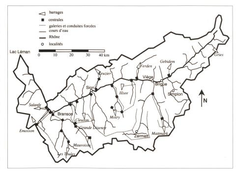
Figure 1. Représentation schématique du réseau hydrographique du Valais et des principaux aménagements hydroélectriques avec leurs galeries d'amenées et conduites forcées.
