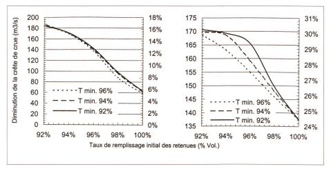
Figure 10. Analyse de sensibilité du taux initial de remplissage des retenues (en amont de Branson) et du taux T<sub>min</sub> marquant l'enclenchement préventif du turbinage. A gauche pour Branson, à droite pour Viège.
