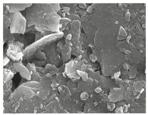
Bild 5. REM-Aufnahme von Sedimentteilchen aus einer Wasserprobe vom lk 1. Zur Aufbereitung wurde das Probenwasser mit einem Filter der Porengrösse 0,45  $\mu$ m filtriert und ein Teil aus dem Filter herausgeschnitten. Die Breite des Bildes entspricht einer Länge von 11,9  $\mu$ m.
