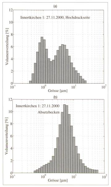
Bild 4. Korngrössenverteilung für eine Probe (a) von der HD-Seite und (b) aus dem Absetzbecken im Ik 1.
