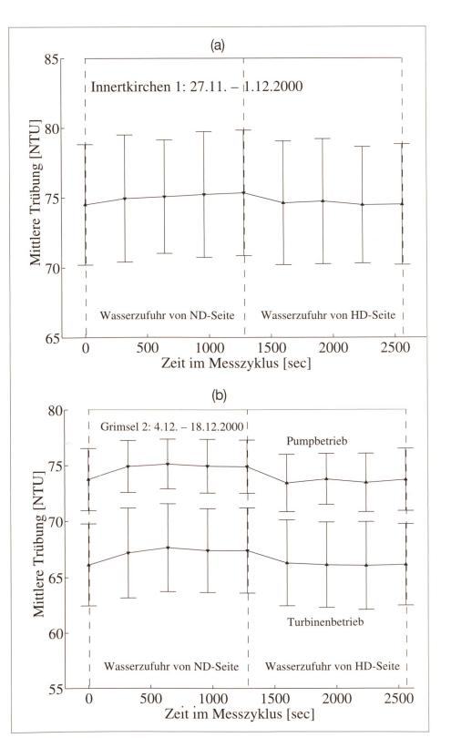
Bild 6. Mittlerer Verlauf eines Zyklus für die Daten (a) vom lk 1 und (b) vom Gr 2. Der erste und letzte Wert in einer Figur sind jeweils identisch. Die vertikalen Balken entsprechen den Standardabweichungen der Messwerte; die Zeitpunkte, bei welchen das Relais umschaltet, sind durch gestrichelte Vertikallinien markiert.
