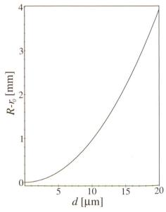
Bild 9. Auf die Oberfläche prallende Partikel als Funktion der Grösse d: Partikel, welche weniger als  $R - r_0$  von der Bechermitte entfernt sind, treffen auf die Becheroberfläche.
