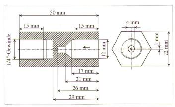
Bild 3. Dimensionen der Düse. Der Pfeil in der Mitte gibt die Strömungsrichtung an.
