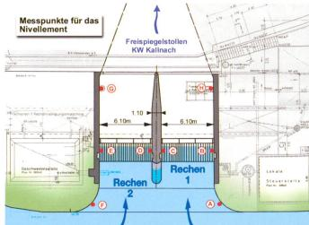
Bild 7. Übersicht der Messpunkte für das Wasserspiegelnivellement.
