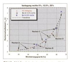
Bild 3. Abhängigkeit des Verlustkoeffizienten vom Blockierungsgrad bei einer variierenden vertikalen Rechteck-Verlegung (0%, 12,5%, 25%) rechts.
