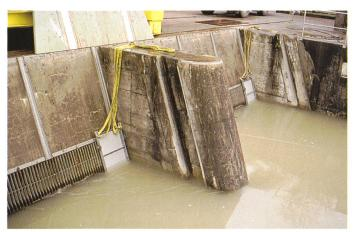
Bild 5. Verlegung für Lastfall 2. Beide Rechenfelder sind jeweils vertikal mit 12,5 % verlegt.
