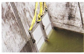
Bild 6. Verlegung für Lastfall 3. Rechenfeld 1 ist mit 25 % verlegt. Rechenfeld 2 ist unverlegt.
