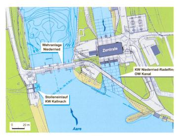
Bild 4. Situation Wasserfassung KW Kallnach, Aare.
