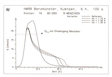
Bild 7. Abminderung der Abflussspitze eines 100-jährlichen Hochwassers durch das Rückhaltebecken Eichmatt/Beromünster in Beromünster (a) und am Ortseingang Menziken (b).
