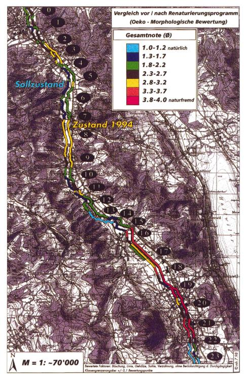
Bild 14. Ökomorphologische Bewertung der Wyna vor und nach Umsetzung des Renaturierungsprogramms.
