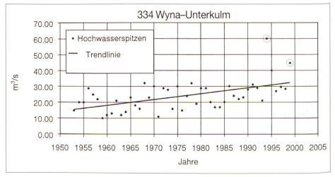
Bild 1. Die Hochwasser-Abflussspitzen der Wyna.
