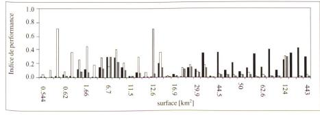
Figure 7. Indices de performance individuels obtenus pour les bassins versants après l'application de la procédure décrite dans cette section (en blanc: la méthode «index-flood»; en noir: la méthode rationnelle; en gris: la méthode selon les règles de décision du tableau 4).
