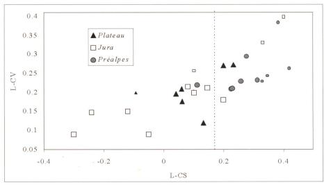
Figure 3. Diagramme des L-moments. Seuls les bassins versants disposant d'au moins 20 ans de mesures sont représentés sur ce graphique. Lorsque les symboles sont de taille réduite, ils correspondent à des bassins versants de moins de 10 km².
