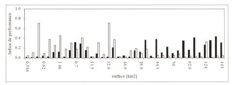
Figure 6. Indice de performance pour la méthode rationnelle (en noir) et la méthode «index-flood» (en blanc). Le temps de retour est ici de 20 ans. Les bassins sont classés de gauche à droite dans l'ordre croissant des surfaces.
