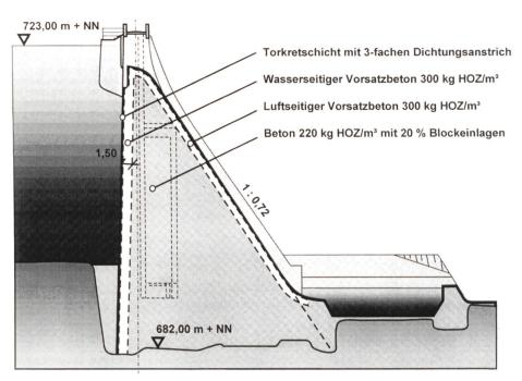
Bild 2. Schwarza-Talsperre – Querschnitt durch die Hochwasserüberläufe.
