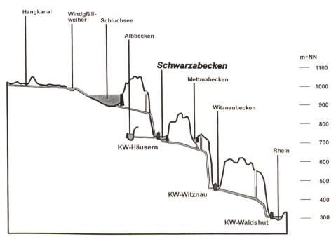
Bild 1. Kraftwerksgruppe Schluchsee - Längsschnitt.
