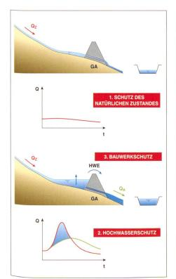
Bild 1. Aufgaben der Regulier- und Sicherheitsorgane von HWRB (GA = Grundablass, HWE = Hochwasserentlastung).
