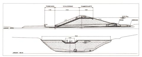
Bild 10. HWRB Villmergen: Geplante Dammscharte mit spezifischer Belastung von  $3 \, \text{m}^3$ /sm für das Bemessungshochwasser.
