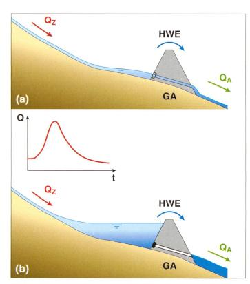
Bild 7. Bemessungsfälle bei HWRB: (a) Hochwasser trifft auf leeres Becken; (b) Hochwasser trifft auf volles Becken.
