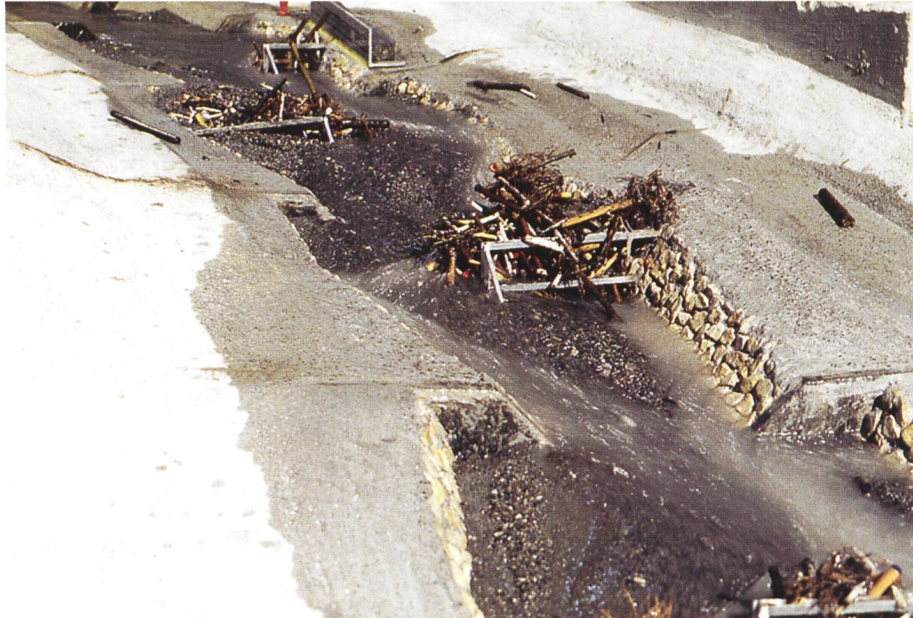
Bild 9. Anordnung mehrerer Bauwerke zum Rückhalt der Wurzelstöcke in der Sperrentreppe des Riemenschaldbachs gegen Ende eines Versuchs für das Extremereignis.
