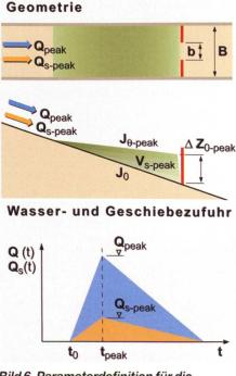
Bild 6. Parameterdefinition für die Vorbemessung einer Schlitzsperre.
