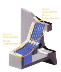
Bild 5. Rechenkonstruktion eines kombinierten Dosier-Sortierwerkes (ergänzt nach Krimpelstätter, 1998).
