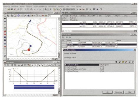
Bild 1. Für die Modellerstellung und die Analyse von Simulationsläufen wird Flux<sup>Designer</sup> verwendet.
