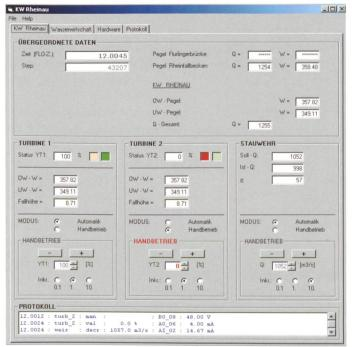
Bild 2. Die grafische Oberfläche von Flux Virtual River wird an die Bedürfnisse der Kunden angepasst. Für die zentralen Aufgaben – wie die Kommunikation mit Floris oder der Hardware-Schnittstelle stehen allgemein gehaltene und leicht parametrierbare Module zur Verfügung.
