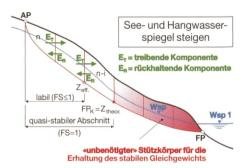
Bild 4. Gleitkörper mit FS = 1.
