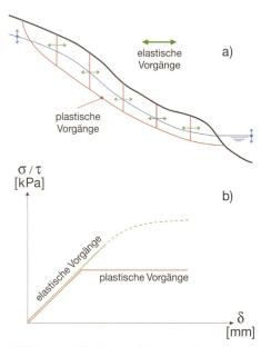
Bild 6a und 6b. Darstellung der elastischen und plastischen Vorgänge.
