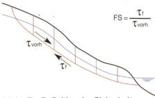
Bild 1. Zur Definition des Sicherheitsgrades FS.
