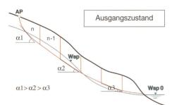
Bild 3. Typischer Verlauf des Neigungswinkels der Gleitfläche.
