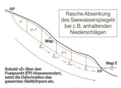
Bild 5. Gleitkörper instabil bis zum Fusspunkt.
