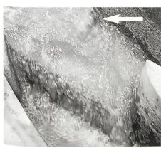
Bild 9. Streichwehr sowie überströmte Buhne mit Fliesswechsel ( $\leftarrow$ ) für  $Q_z = 6.5 \, \text{m}^3/\text{s}$ , Blick gegen Fliessrichtung.
