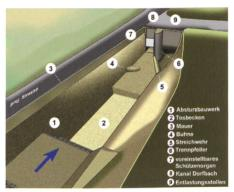
Bild 6. Schematische Ansicht der Lösungsvariante.
