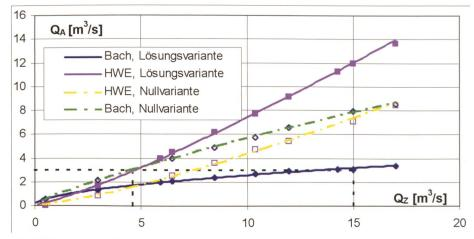
Bild 5. Trenncharakteristik des Streichwehrs der Projektvariante und der Lösungsvariante.
