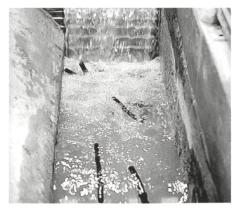
Bild 13. Schwemmholz im Tosbecken bei  $Q_z = 3.0 \text{ m}^3/\text{s}$ .
