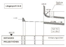
Bild 11. Längenprofil B-B (Grundriss siehe Bild 7) durch das Streichwehr, den Sammelkanal und den HWE-Einlauf.
