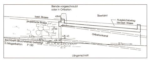
Bild 4. Längsschnitt durch das Verzweigungsbauwerk der Projektvariante.
