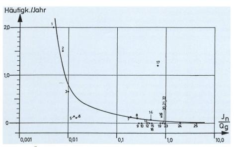
Bild 4a. Die Überlaufwahrscheinlichkeit in Abhängigkeit von der Speicherkennziffer [3].
