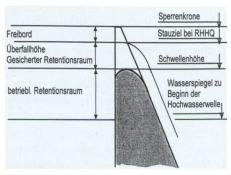
Bild 2. Hochwasserentlastungsanlagen, geometrische Bezeichnungen.
