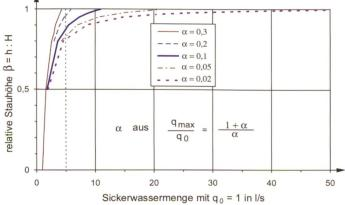
Bild 13. Abhängigkeit der Sickerwassermenge von der Stauhöhe für verschiedene Werte von α.
