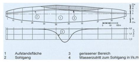
Bild 9b. Wasserzutritte zum Sohlgang der Bogengewichtsmauer Schlegeis.
