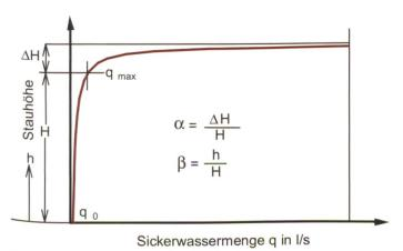
Bild 12. Hyperbolischer Verlauf der Sickerwassermenge in Abhängigkeit von der Stauhöhe.
