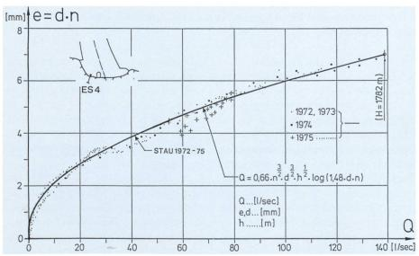
Bild 11. Wasserzutritte zum Sohlgang in Abhängigkeit von den Felsverformungen [9].
