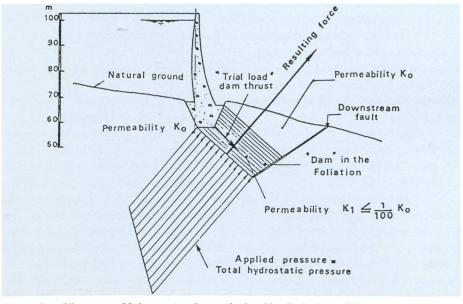
Bild 8. Gewölbemauer Malpasset, schematischer Vertikalschnitt [6].
