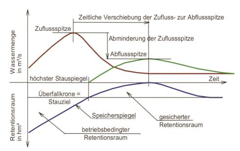
Bild 3. Abminderung einer zufliessenden Hochwasserwelle durch den Retentionsraum.
