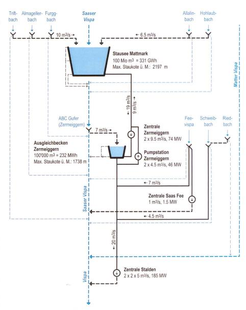
Bild 4. Speicherkraftwerk Mattmark - hydraulisches Schema.
