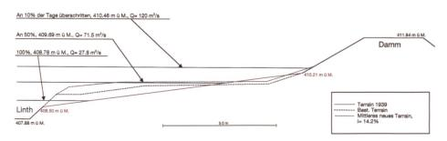
Bild 4. Profil 39 mit gegenwärtigen (in Schwarz) und geplanten Terrainhöhen (in Rot) und dem Schwankungsbereich der Pegelstände in der Larvalphase.
