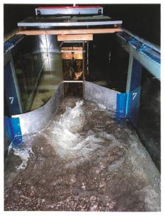
Bild 5. Hydraulischer Modellversuch im Wasserbaulabor der Hochschule Rapperswil (Einlauf Rechter Hintergraben) (max. Dotierwassermenge 5 m³/s).
