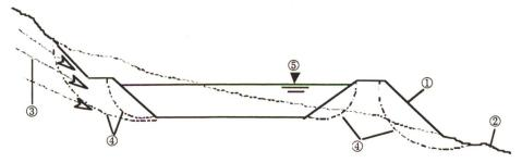
Bild 1. Speicherbecken im Hanganschnitt. ① Dammschüttung, ② natürliches Terrain, ③ Grundwasser-Sickerströmung, ④ Gleitflächen, ⑤ Staukote.
